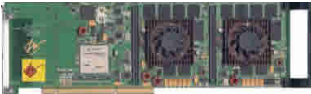
Annapolis PCI-kort kan bestyckas med en eller två FPGA-kretsar. Priset börjar kring 25 000 dollar.
