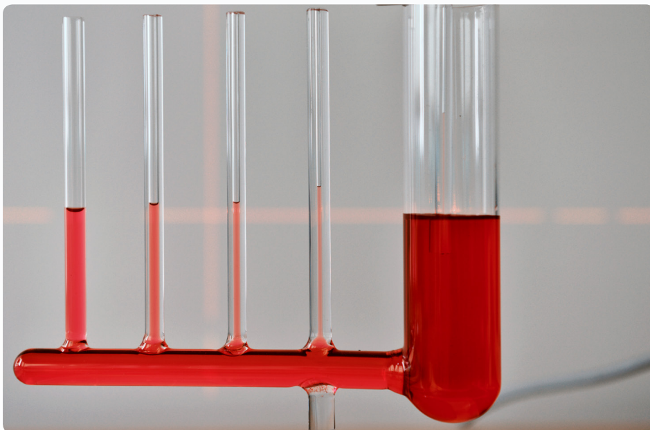
Kapillär stighöjd i olika kapillärrör med påslagen avfuktningssapparat. Den kapillära stighöjden påverkas inte av apparaten, inte ens efter flera dygn.
