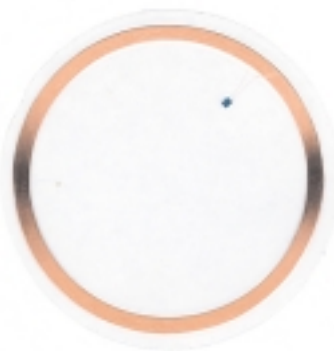
Transponder av den typ som ofta finns ingjutna i kontaktlösa passerkort.
