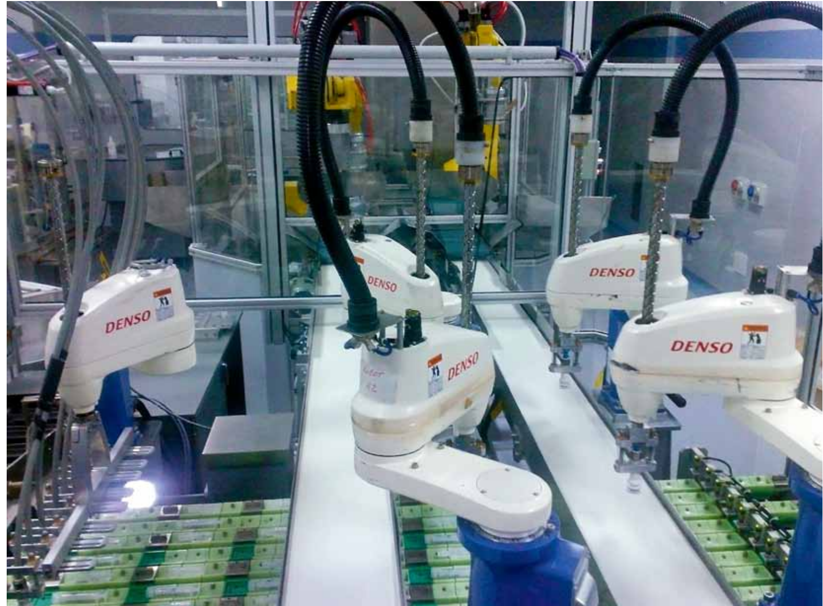
Kameror gör robotar flexibla och skalbara. Monteringslinjer kan hantera delar som får ändrad form men även plocka delar som ligger huller om buller i en låda.
